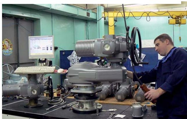
Подготовка к проверке технических характеристик привода ЭПАС-О-30.1
