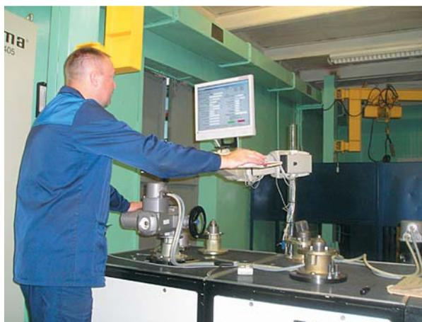
Стенд PV 1405 (AUMA) для диагностики электроприводов ЭПАС
