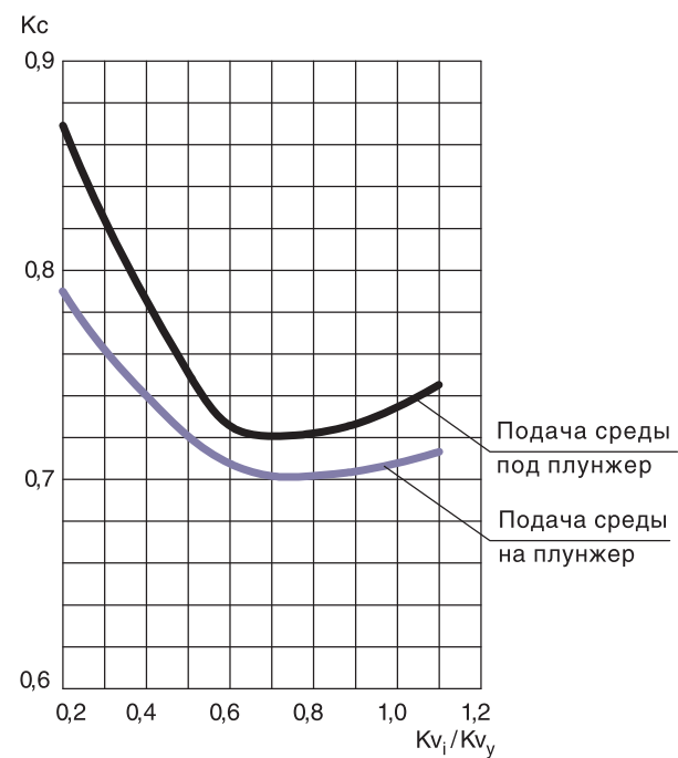
Зависимость коэффициента начала кавитации от относительной пропускной способности K_c=f(Kv_i/Kv_y)
