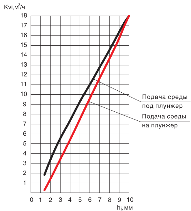
Зависимость пропускной способности от хода плунжера Kv_i=f(h_i)
