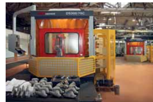
Механическая обработка корпусных деталей на обрабатывающих центрах
