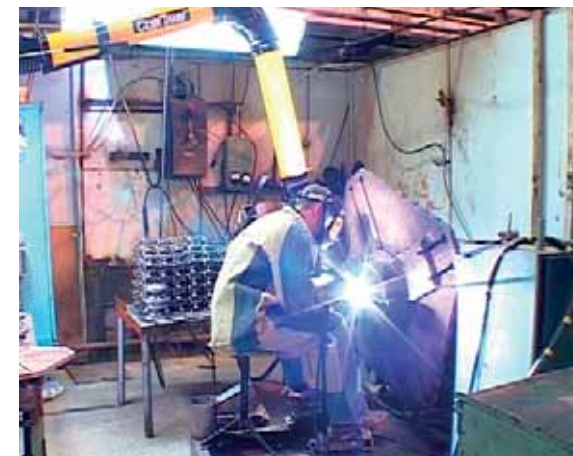
Ручная сварка корпусных деталей
